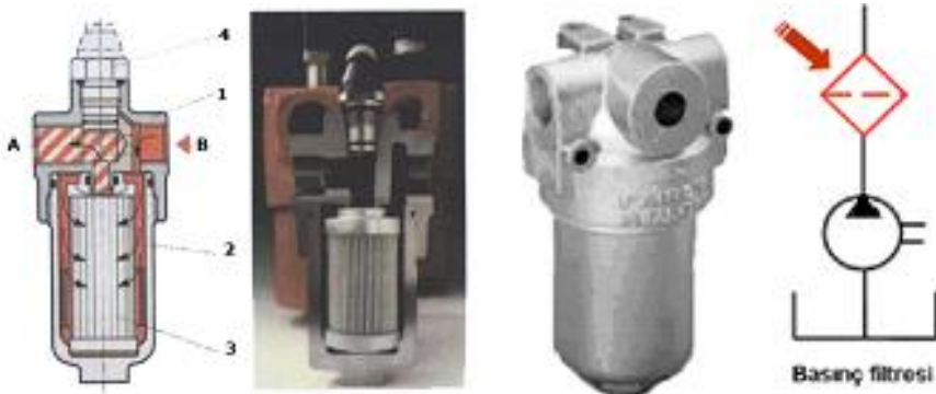
řekil 2.6: Basın filtresi, alıřma prensibi ve sembolü
