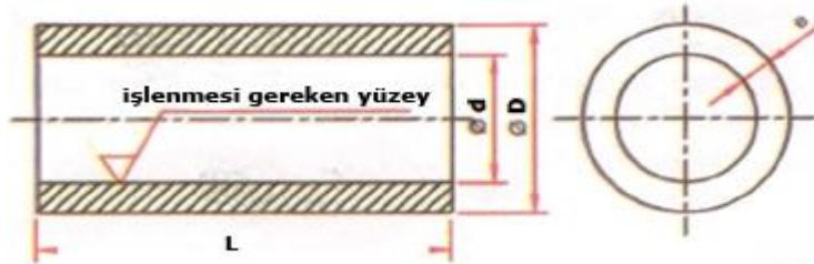
Şekil 6.2: Silindir gömlek kesiti
