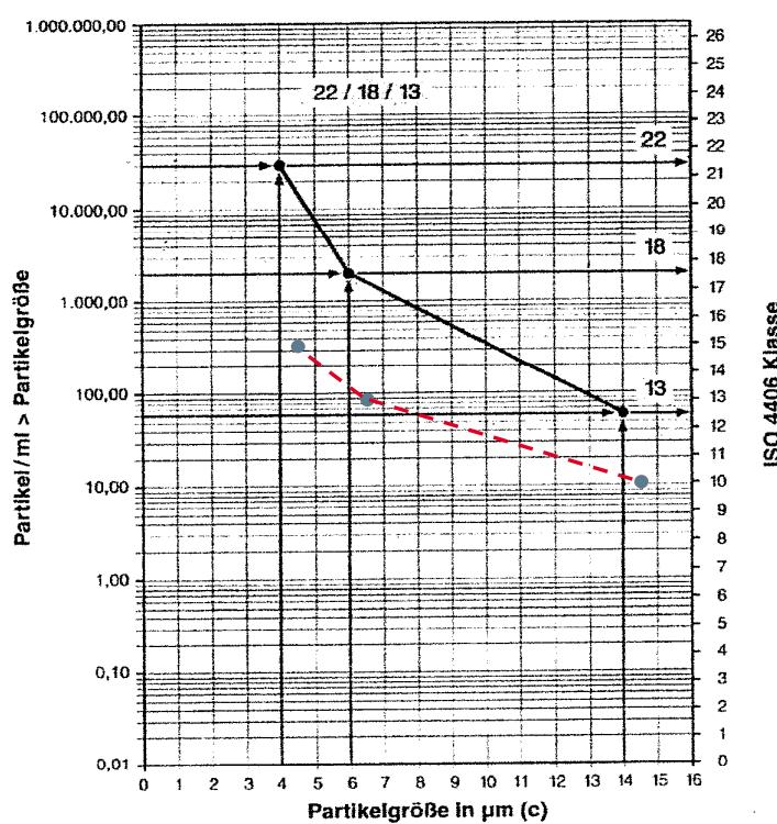
**Charakteristischer Kurvenverlauf einer Flüssigkeit mit Verschmutzungsklasse 22/18/13 und zum Vergleich: 20/18/15**
