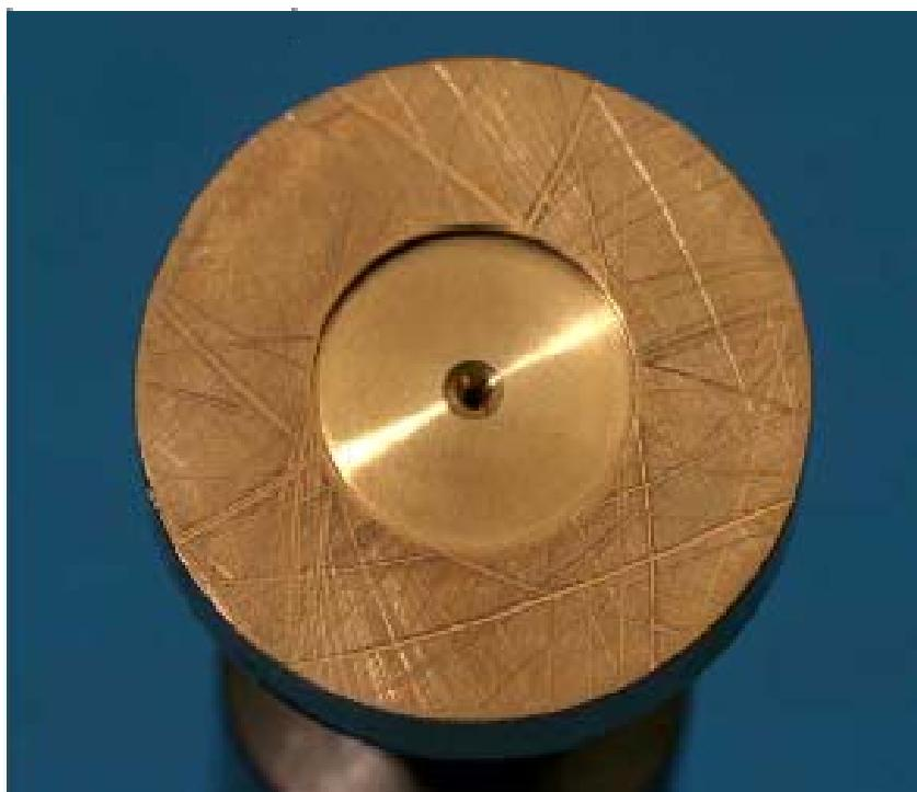
Kontaktfläche des Kolbengleitschuhs mit Gegenfläche: Kontaktfläche der Schwenkwiege
