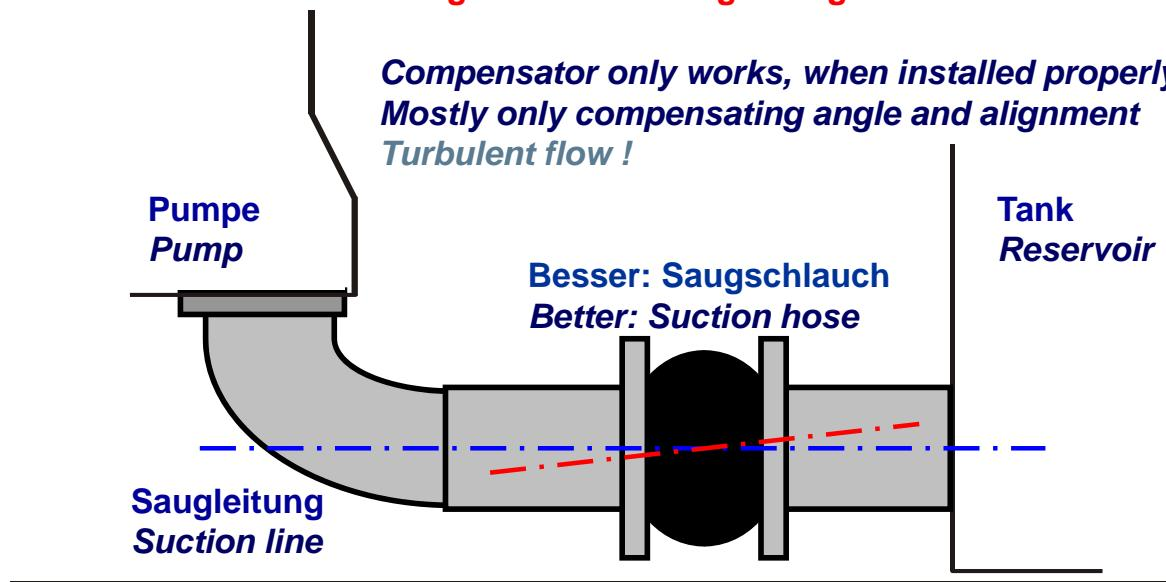
**Bei langen Saugschläuchen Gefahr von Luftsackbildung**
